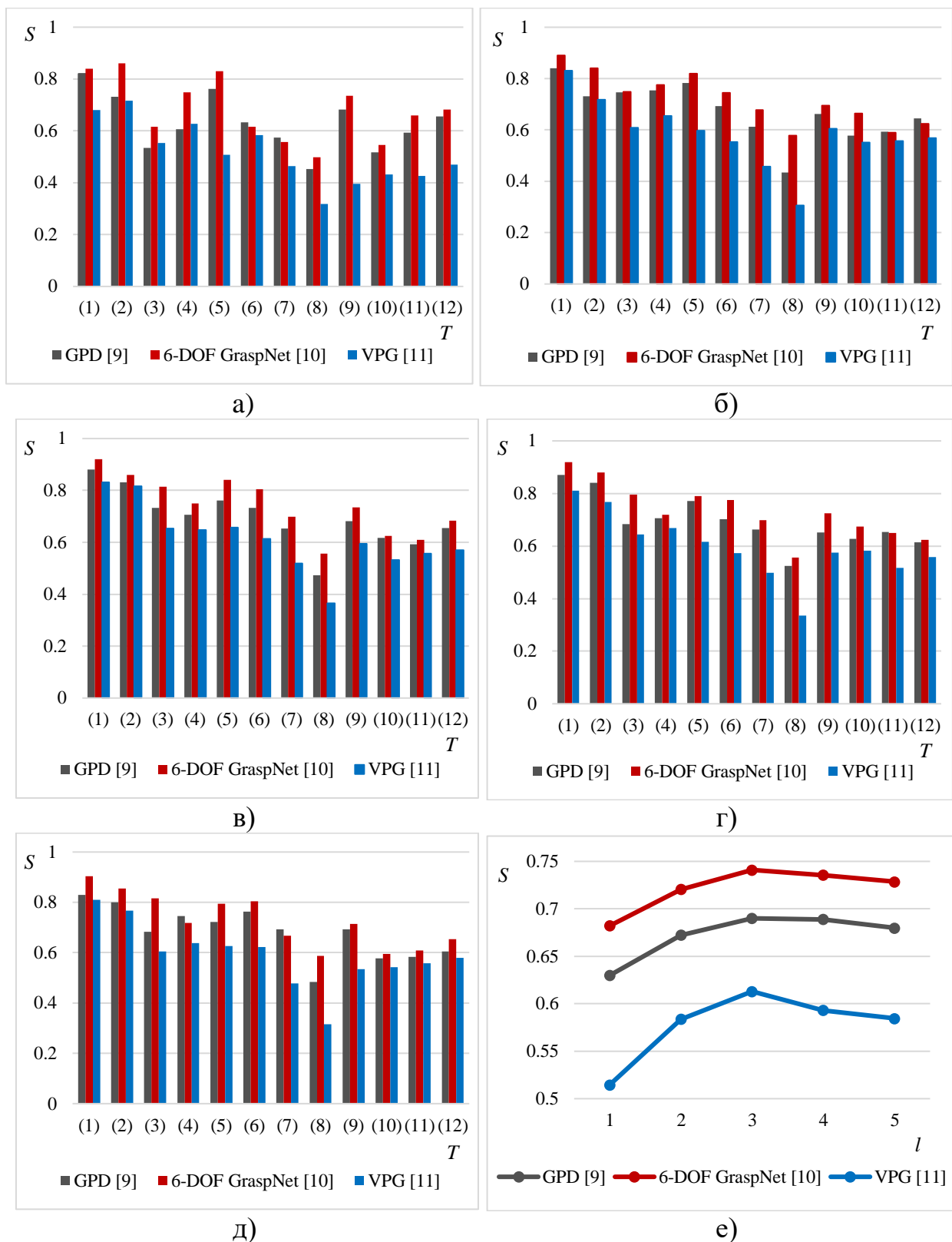
Рисунок 19 – Оценка влияния размеров ЦО l на качество работы исследуемых методов: а) l = 1 ; б) l = 2 ; в) l = 3 ; г) l = 4 ; д) l = 5 ; е) усредненная по T оценка вероятности успешного захвата ЦО в зависимости от l
