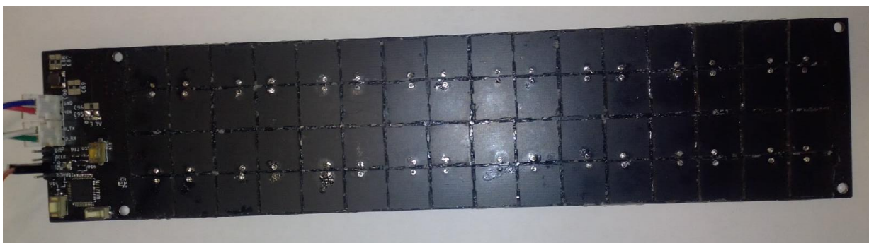
Рисунок 14 – Матрица датчиков давления и приближения на 64 ячейки
