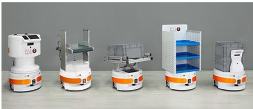
Рис. 11. TIAGo Base и варианты устанавливаемых модулей
