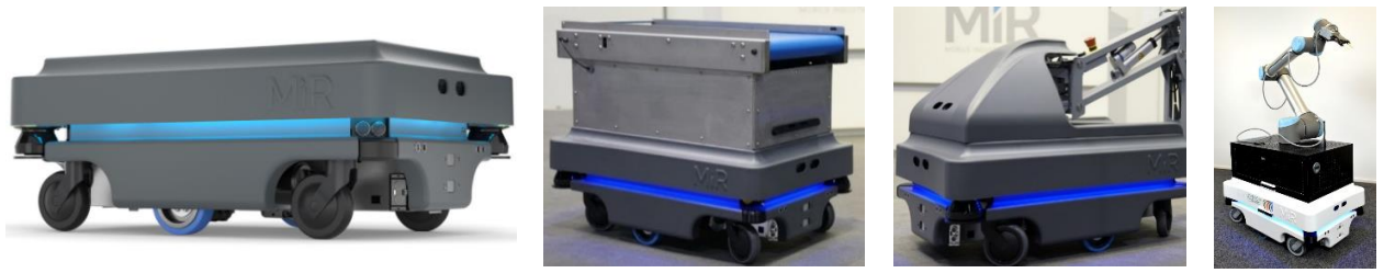
Рис. 13. Мобильная платформа MiR 200 и устанавливаемые модули
