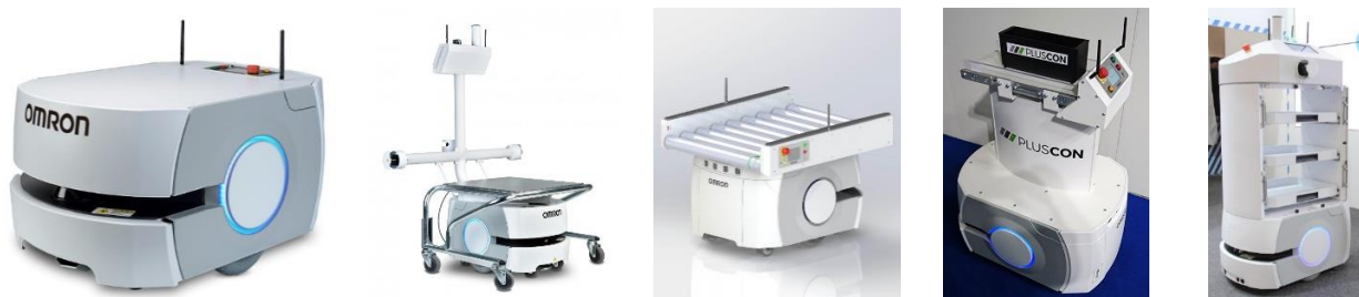
Рисунок 12. Мобильная платформа OMRON LD-60/90 и устанавливаемые модули
