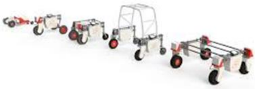
Рис. 7. Модульный робот Thorvald II
